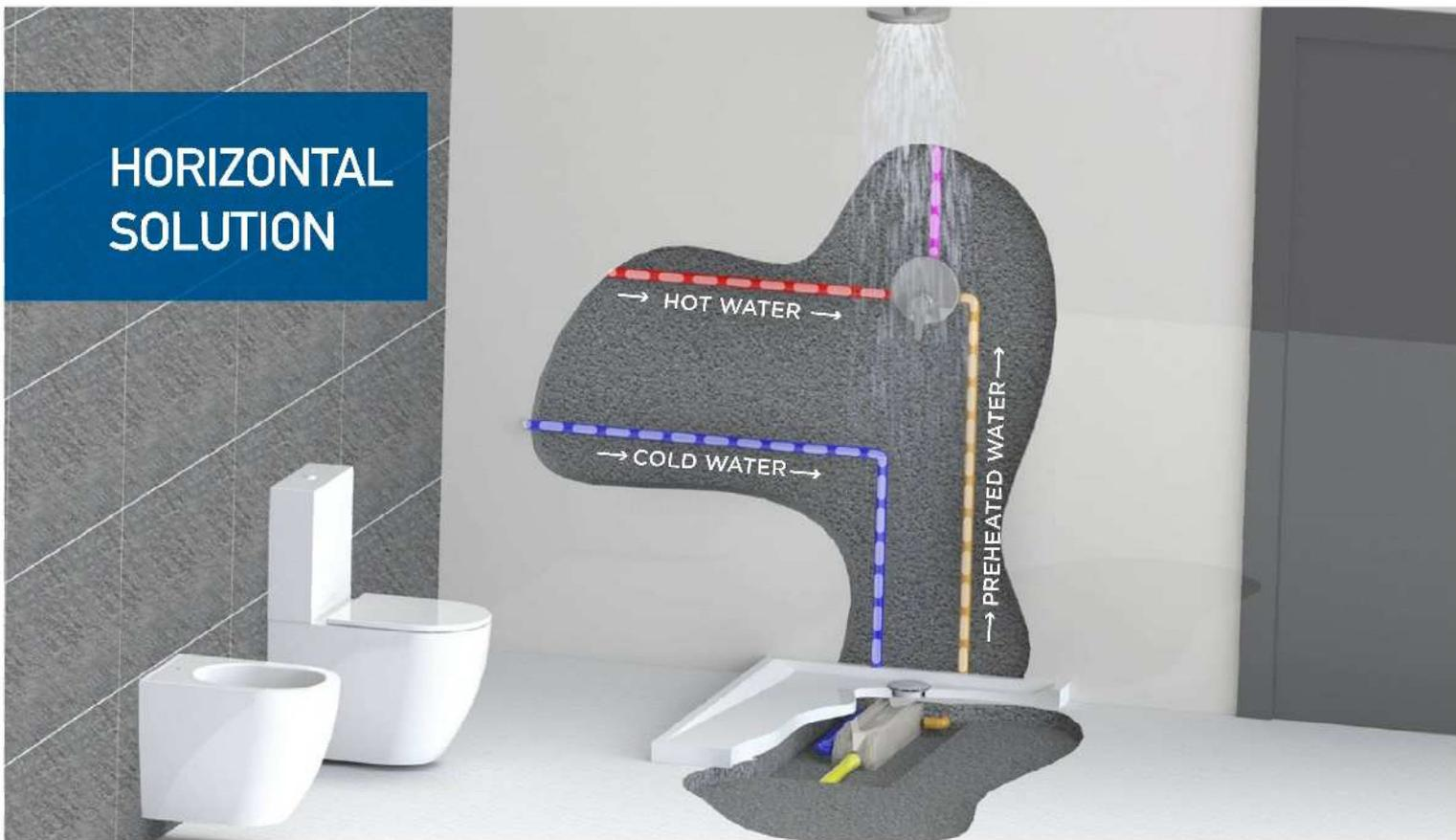
ZYPHO（ザイフォー）は、シャワー排水の熱(40℃)を冷水(10℃)に伝えます。この予熱された水(最大31℃)は、シャワー混合栓や給湯ボイラー、またはその両方に供給されます。エネルギー消費を25%~67%削減し、エネルギー効率を改善します。
