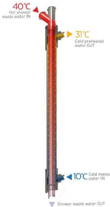
PiPe65は、シャワールームやユニットバスに適応可能な垂直式シャワー排水熱回収装置です。シャワー使用後のまだ温かい排水から、熱のみを冷水に伝達します。この予熱された冷水は、シャワー混合栓の給水やボイラー、またはその両方に供給されます。
